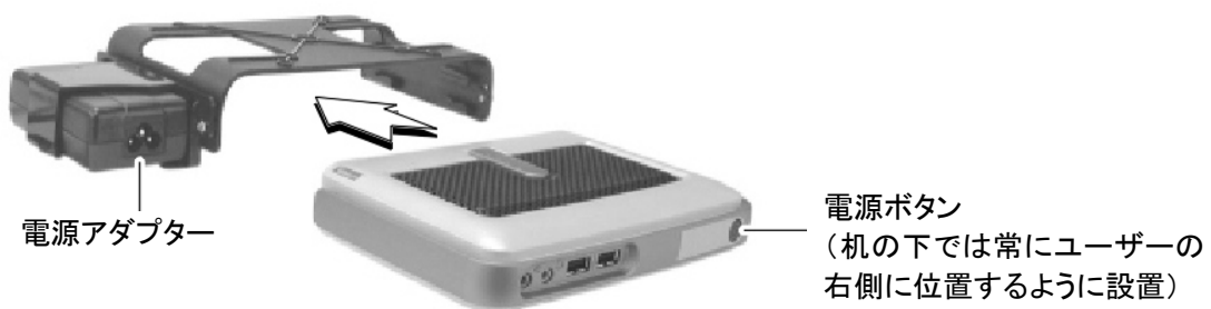
図 3 机の下への取り付け方法
